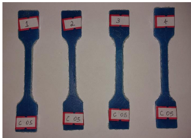
Figura 10. Modelo impresso para teste tração com 0,5% de fibra de curauá.
