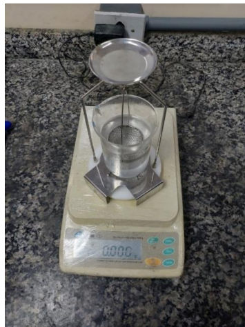
Figura 8. Balança hidrostática utilizada para a determinação da densidade pelo princípio de Arquimedes.
