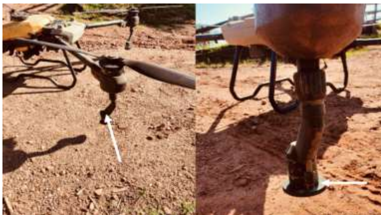
Figura 2 - Bicos centrífugos (seta branca) duplos do Drone DJI AGRAS T20P
