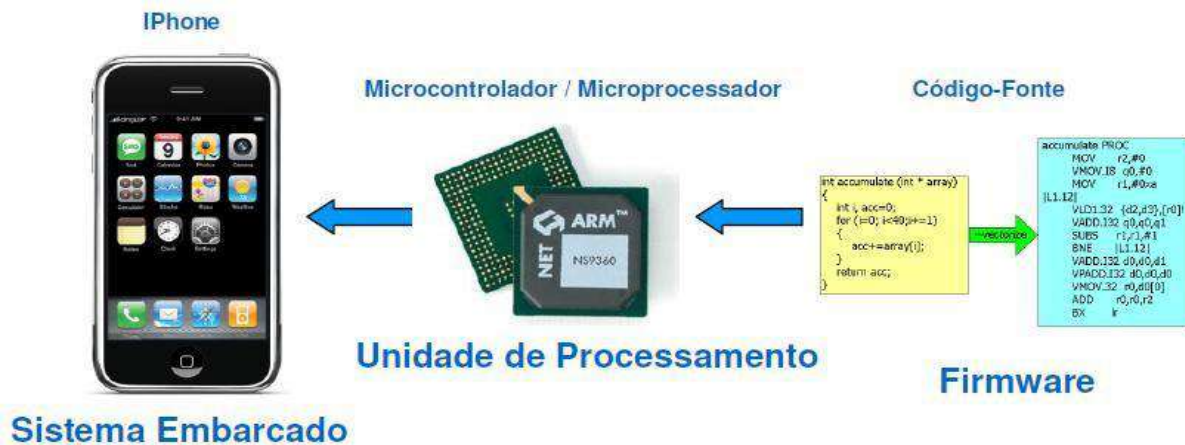
Figura 2: Lógica de funcionamento de um Sistema Embarcado
