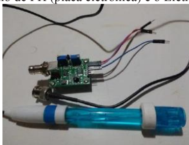
Figura 4: Modulo de PH (placa eletrônica) e o Eletrodo de PH (azul)
